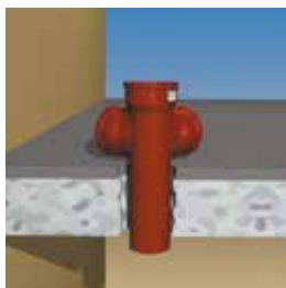
Monter det nye lange grenrøret i dekket
